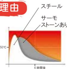
サーモストーンはスキャンサーム独自の蓄熱システム。炎からの熱をよく吸収し、何時間にもわたって熱を放出し続けます。
